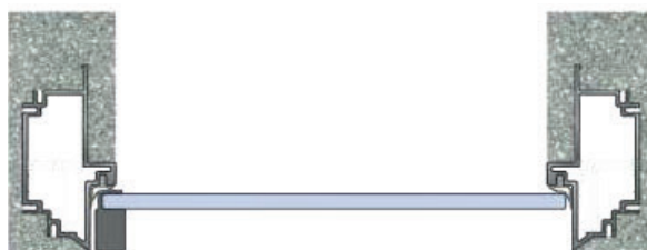
Rys. 2 – DRZWI ZLICOWANE ZE ŚCIANA, OTWIERANE NA ZEWNĄTRZ
