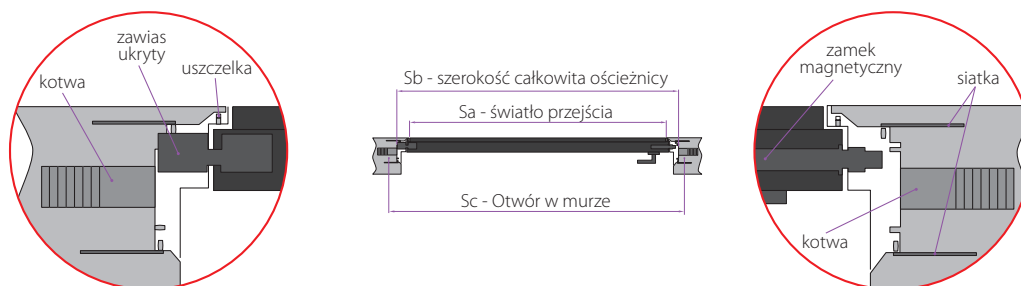
Rys. 3 – PRZEKRÓJ OŚCIEŻNICY SKRZYDŁA OTWIERANEGO DO ŚRODKA (typ A)
