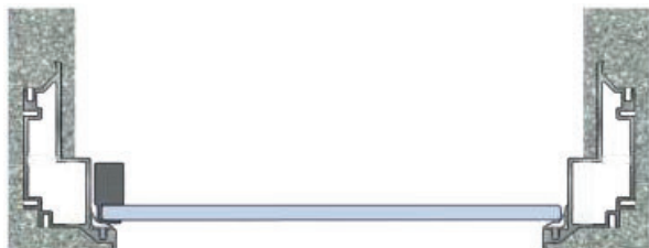
Rys. 1 – DRZWI ZLICOWANE ZE ŚCIANA, OTWIERANE DO ŚRODKA
