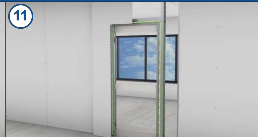
11 Dołóż płyt GK, tak aby był czysty nadgórny belk okna.
